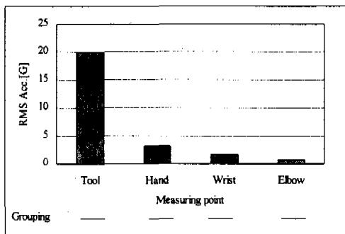
그림 9. 측정점에 따른 진동 가속도의 크기 및 Duncan test 결과
