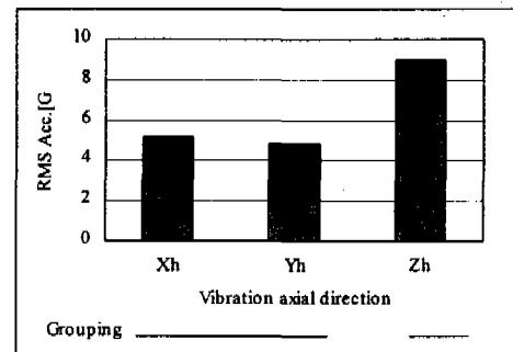
그림 8. 진동방향에 따른 진동 가속도의 크기 및 Duncan test 결과
