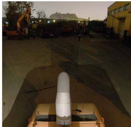
그림 10. 후사경 시계성 측정(prototype 방법)
