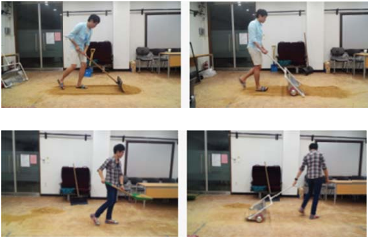
Figure 3. 실험장면 (상: 눈치우기, 하: 눈운반하기, 좌: 기존 도구, 우: 새로운 디자인 도구)
